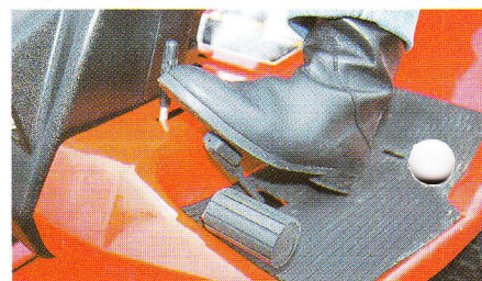
Ontgrendeling van de 4-wiel aandrijving.
